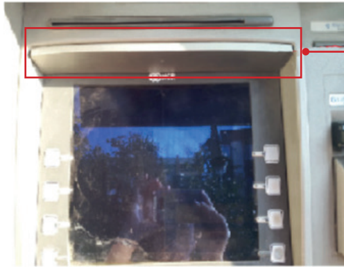
Görsel 15: Kamera ile şifre alma kaynak: TBB – Çalışma Grubu
