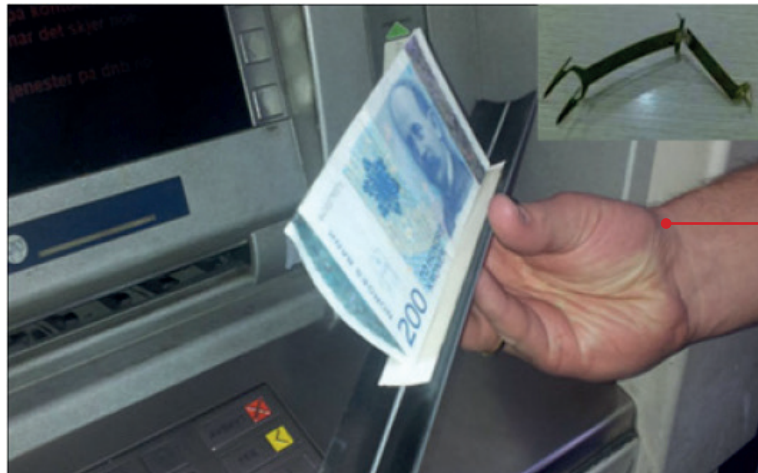
Görsel 20: Para sıkıştırma aparatı Kaynak: TBB – Çalışma Grubu
