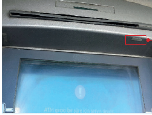
Görsel 14: Kamera takılıp söküldüğünü gösterir kalıntılar Kaynak: TBB – Çalışma Grubu
